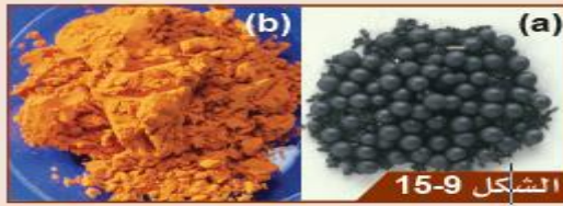
الشكل 9-15 تمّ استخلاص فلزّ الحديد (الصورة a) من أكسيد الحديد (II) الأصفر اللون (الصورة b).
